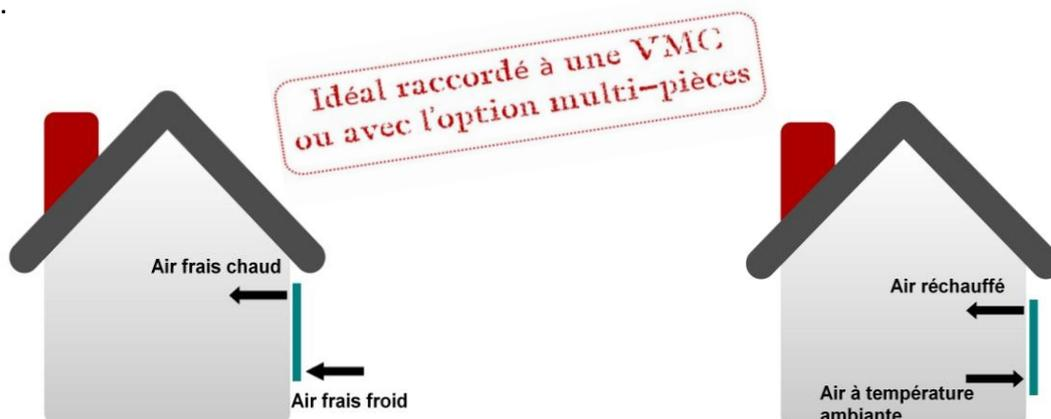
Fonctionnant grâce au **soleil** ou raccordé au **réseau électrique**, le **ventilateur** permet de faire circuler l'air chauffé, soit gratuitement grâce au soleil, soit de manière continue.
